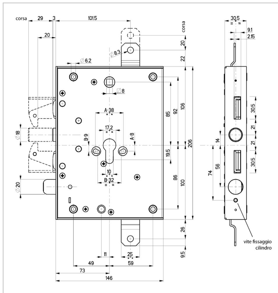
Il chiavistello tradizionale viene sostituito da uno speciale chiavistello con chiusura a “gancio” che permette il formarsi di un tutt’uno fra serratura e telaio per una maggiore sicurezza.
