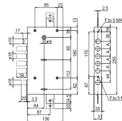
**1618 • Serratura da applicare con BLOCCO DI SICUREZZA**
