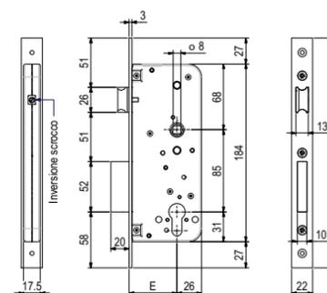
**R1080 • Serratura centrale ad ingranaggi con riduttore di coppia
