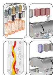
**La cifratura.** Doppio sistema di cifratura meccanico con l'aggiunta della sicurezza matematica. La tradizionale cifratura con perni a molla si abbina ad un sistema di cifratura con perni coassiali rotanti sulla nuova doppia curva desmodromica e ad un perno sagomato "matematico" (brevettato), per portare il cilindro al massimo livello di sicurezza contro i tentativi di manipolazione illecita.
