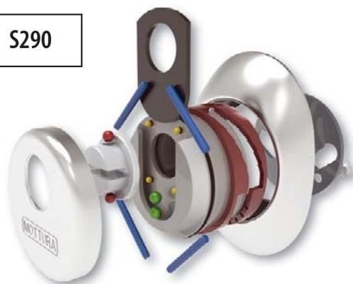
Sfere d'acciaio a protezione del corpo del cilindro e sulla rondella cromata + una piastra al manganese + quattro spine a protezione della mostrina per una protezione totale
